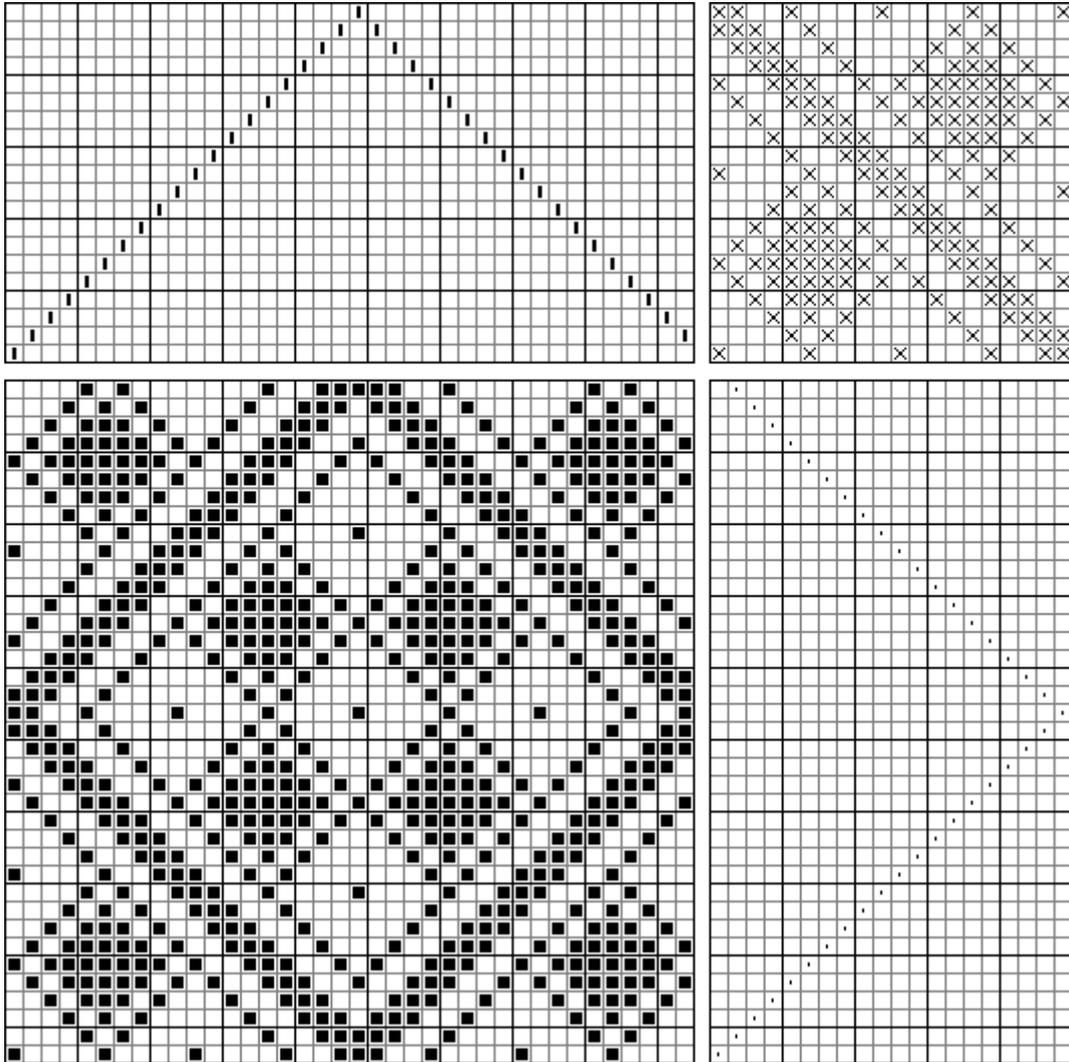
Armure gaufrée sur 20 cadres, rapport : 38 fils dans le sens de la chaîne et de la trame.
